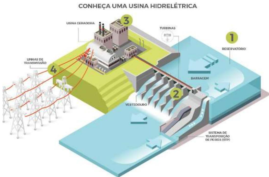
Esquema de funcionamento de uma Usina Hidrelétrica
